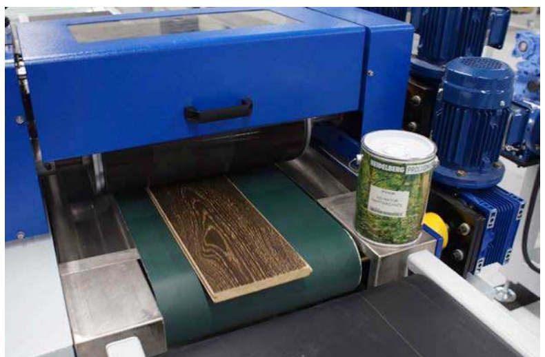
Mit Heidelberg-Produkten eingefärbt und geölt kommt die Parkettziele aus der zweiten Auftragswalze und fährt in die UV-Trocknung.
